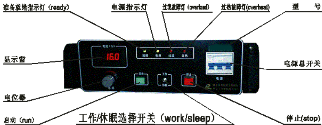
图九：面板正视图（无外控）
